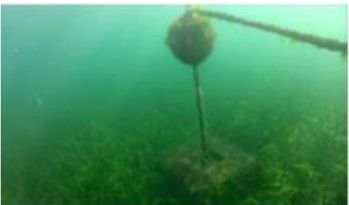
Système de mouillage d'Imer : bouée intermédiaire (AFB, 2016)
