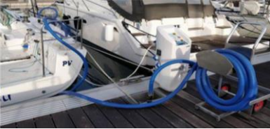
Equipement d'aspiration des eaux noires © Internet
