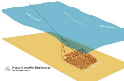
Schéma de drague « bretonne ». Source : CDPMEM 29
